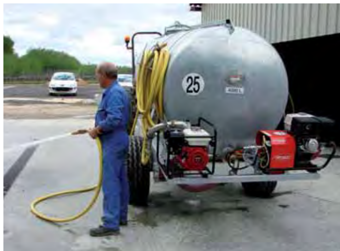
Dispositif autonome permettant de laver l'extérieur du pulvérisateur
