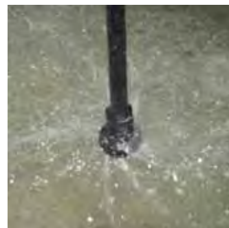
Buses de rinçage permettant de laver les parois internes de la cuve du pulvérisateur
